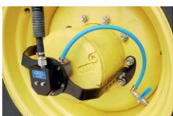
Ce système est installé de manière permanente sur le véhicule. Une seule conduite est reliée à chaque roue et est munie d'un robinet permettant d'isoler la valve. Pour modifier la pression, l'utilisateur doit descendre du tracteur
