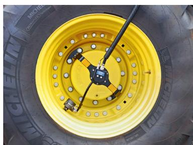
Ces systèmes, plus avancés, nécessitent généralement deux conduites et une soupape de commande montée sur le moyeu de la roue. L'air comprimé est acheminé jusqu'à la soupape, qui reste fermée au repos. Le système contrôle environ toutes les cinq minutes la pression du pneumatique et la compare à la pression de consigne.
