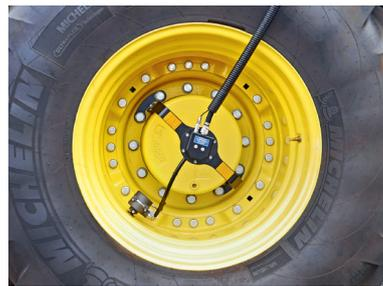
Diese fortschrittlicheren Systeme benötigen in der Regel zwei Leitungen und ein Steuerventil, das auf der Radnabe montiert ist. Die Druckluft wird zum Ventil geleitet, das im Ru-
