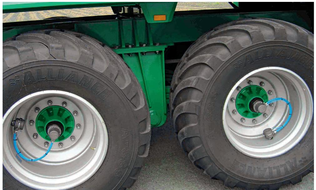
Obwohl diese Lösung höhere Anschaffungskosten mit sich bringt, ist sie für eine intensive Nutzung des Reifendruckregelsystems optimal.
