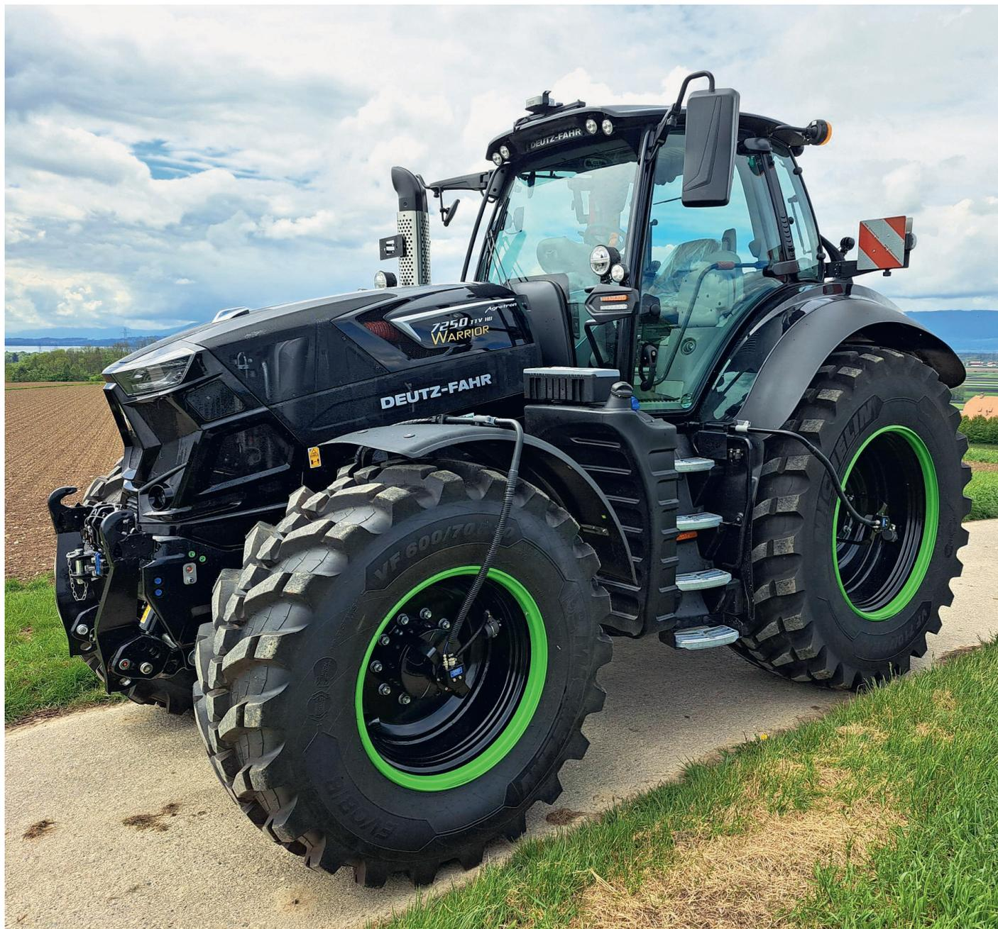
Deutz-Fahr 7250 mit Zwei-Leitungs-Reifendruckregelsysteme
