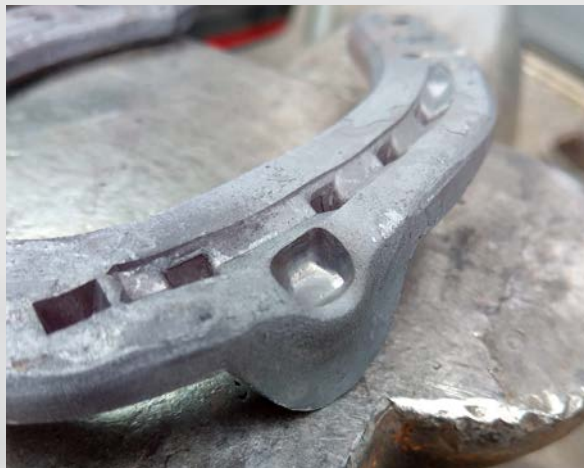
Das Bild zeigt, wie der Bop-Punch zusätzliches Material für die Erhöhung nach aussen treibt. La photo montre comment le Bop-Punch pousse le matériau supplémentaire pour renforcer le pinçon vers l'extérieur.
