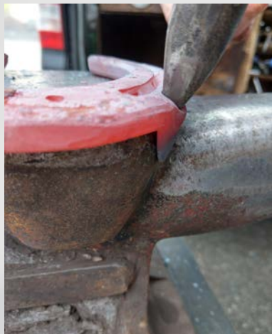
Kappe nachziehen: Bop-Punch setzen Renforcer le pinçon : appliquer le Bop-Punch
