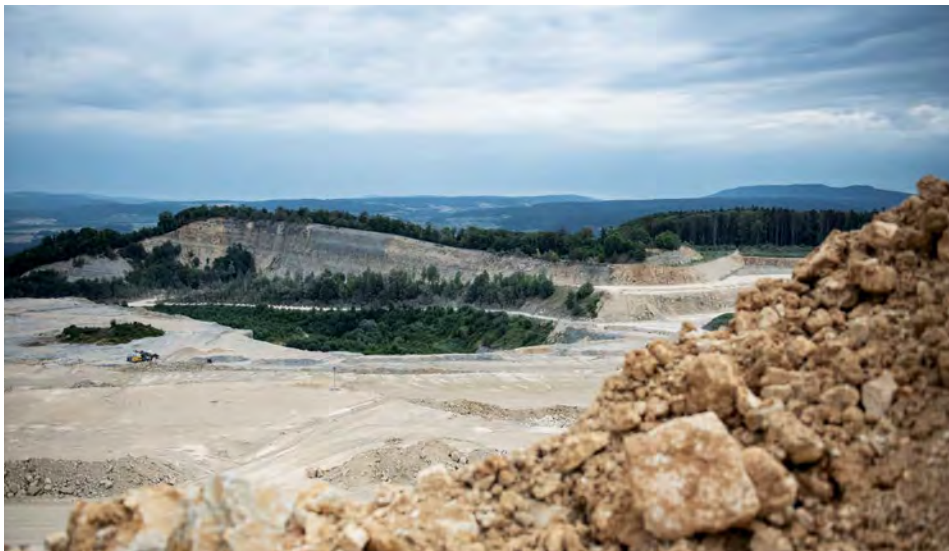
Le calcaire et la marne extraits de la carrière du Gabenchopf de Holcim (Suisse) SA à Siggenthal (AG) servent à fabriquer le clinker utilisé pour le ciment Susteno qui ménage les ressources naturelles.
