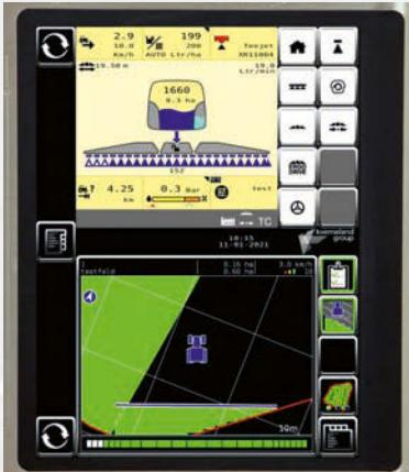
Durch GPS-Unterstützung und Section-Control können Überlappungen vermieden werden, was zu einer Reduktion der Spritzmittel führt. Quelle: Agriott, Peter Aregger
