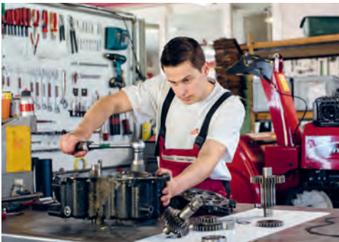
Démontage d'un système d'entraînement.
