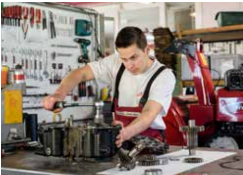
Ein Getriebe wird zerlegt.
